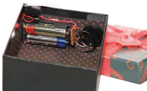
شکل ۲۸-۴. جانیمایی مدار پروژه و کلید
