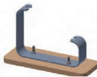
شکل ۳۹-۵. متصل کردن قطعه‌ها با پیچ و مهره
