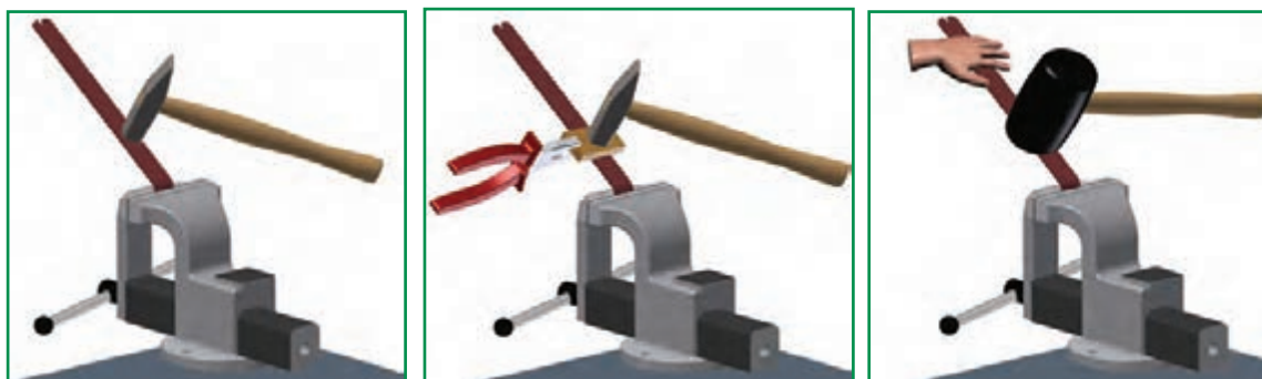
(پ) خم کاری با چکش فلزی
