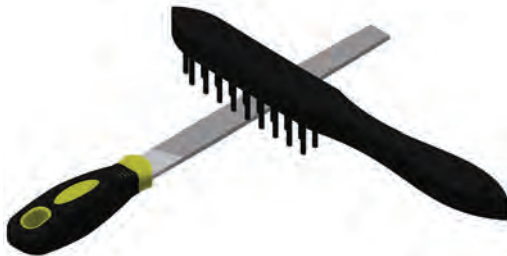
شکل ۵-۱۷. تمیز کردن سوهان با برس سیمی
