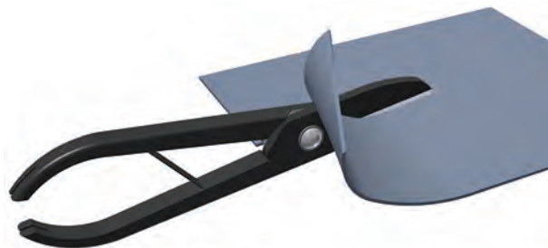
شکل ۵-۶. قیچی کاری ورق
