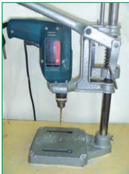
شکل ۵-۲۸. دریل دستی روی پایه
